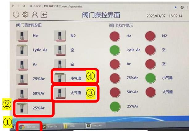
如遇当前气体不同, 手动切换。1、打开google浏览器 2、选择切换气体种类 3、大气流冲洗5min 4、切换小气流。
